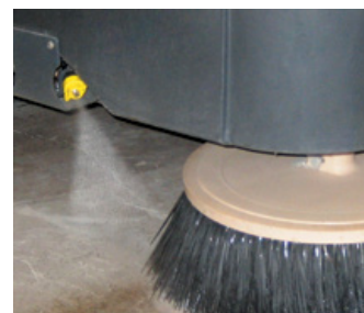
Dustguard™ : système de contrôle de la poussière
